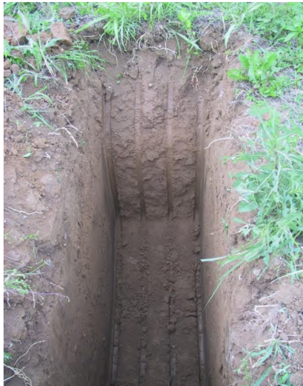
Fig. 7: Trincea esplorativa realizzata nell'anno 2007 per il progetto del precedente ampliamento.
