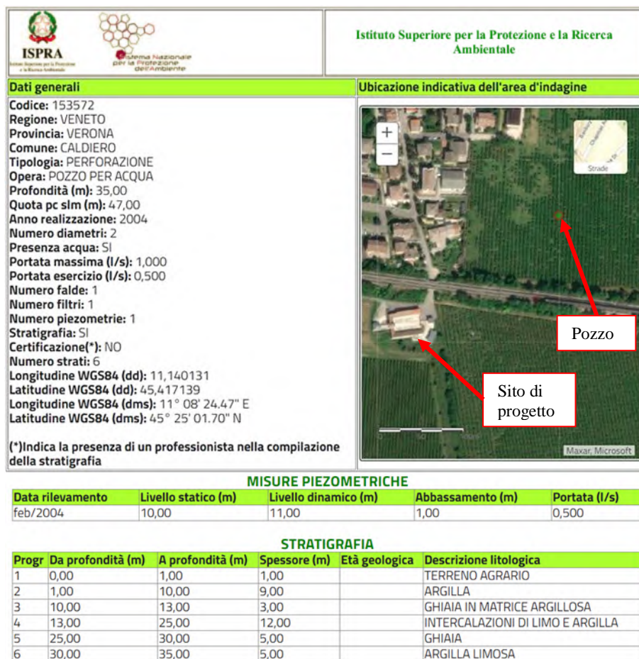
Fig. 6: Pozzo 153572 dell'Archivio nazionale delle indagini nel sottosuolo (L. 464/1984).
